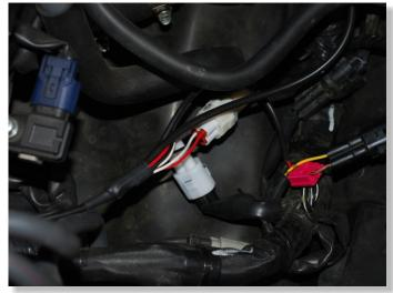
CONNECT THE GPX BLACK/GREEN WIRE TO THE GRAY WIRE OF THE CRANKSHAFT POSITION SENSOR CONNECTOR.
