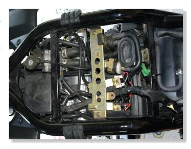
PLUG GPX CONNECTORS IN-LINE
