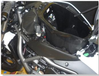
REMOVE THE BATTERY PLASTIC COVER INSIDE HELMET HOLDER BOX.
