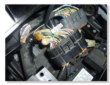
CONNECT X-TRE RED WIRE TO ORANGE/GREEN WIRE OF REAR BRAKE LIGHT SWITCH CONNECTOR.
