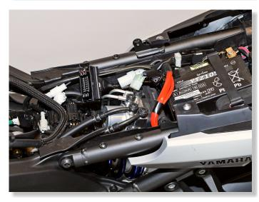
UNPLUG THE ABS ECU CONNECTOR. (BLACK CONNECTOR BEHIND ABS UNIT ON RIGHT SIDE)
