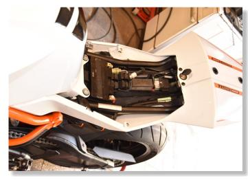
REMOVE THE LEFT AND RIGHT SIDE COVERS UNDER THE SEAT.
