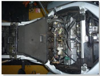
PLUG GPX CONNECTORS IN-LINE
