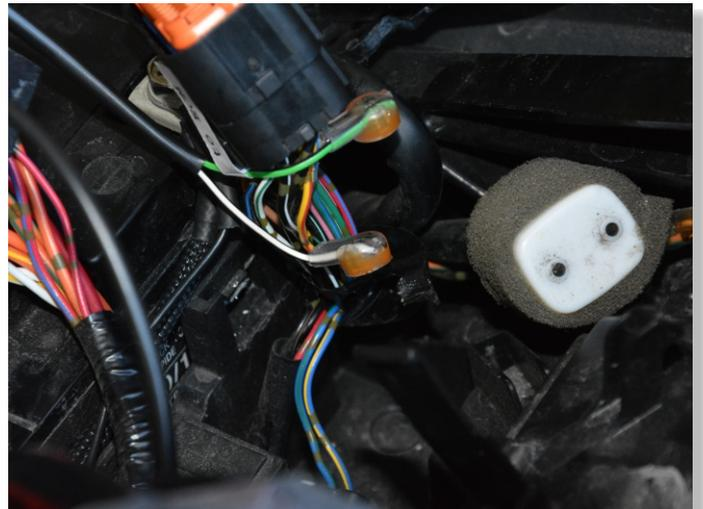
**CONNECT X-TRE RED WIRE TO ORANGE/GREEN WIRE OF REAR BRAKE LIGHT SWITCH CONNECTOR.**
