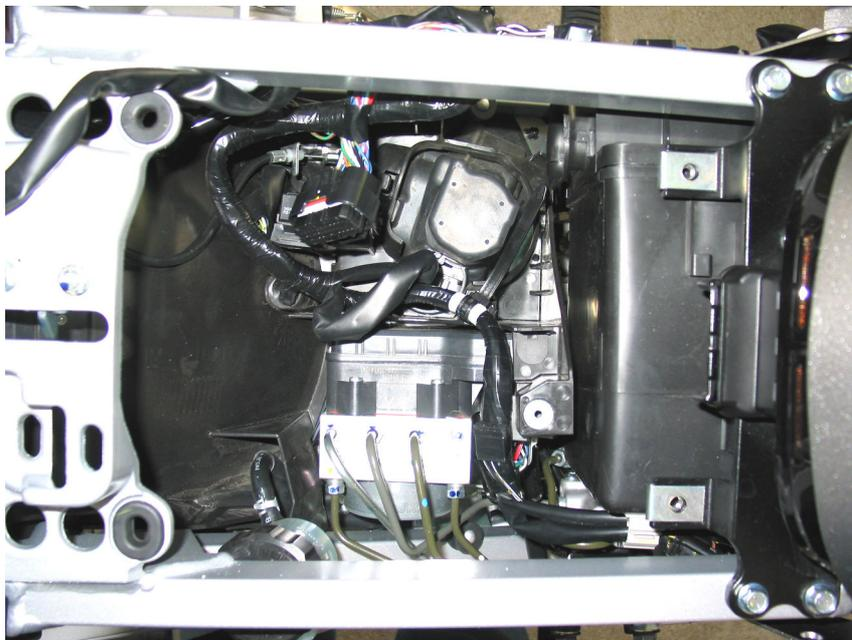
Abb. 1 (Blick von oben auf das ABS-Steuergerät)
