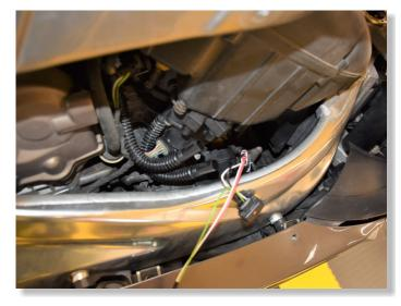
CONNECT THE QSH BLACK WIRE TERMINAL TO THE BATTERY NEGATIVE.
