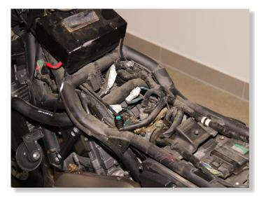
PLUG GPX CONNECTORS IN-LINE
