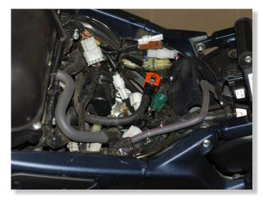
PLUG GPX CONNECTORS IN-LINE
