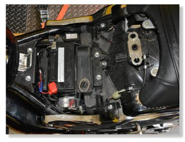
LOCATE THE REAR LIGHT CONNECTOR UNDER MAIN SEAT.
