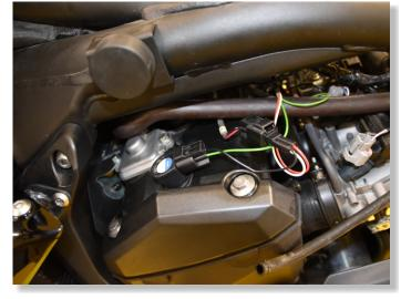
CONNECT THE QSH BLACK WIRE TERMINAL TO THE CHASSIS GROUND.
