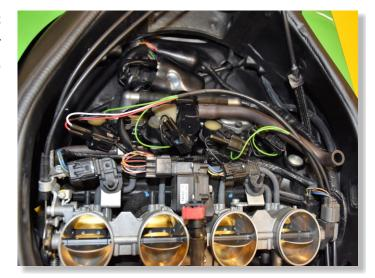
CONNECT QSH BLACK WIRE TERMINAL TO THE BATTERY NEGATIVE TERMINAL.
