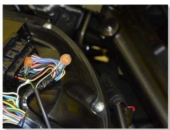
CONNECT X-TRE RED WIRE TO ORANGE WIRE OF REAR BRAKE LIGHT SWITCH CONNECTOR.
