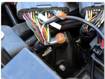
CONNECT X-TRE RED WIRE TO ORANGE WIRE OF REAR BRAKE LIGHT SWITCH CONNECTOR.
