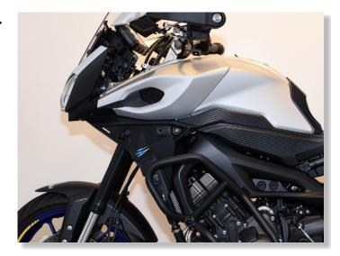
REMOVE THE FAIRINGS AROUND THE FUEL TANK.
