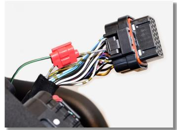
LOCATE THE START/ENGINE STOP SWITCH CONNECTOR AT THE RIGHT SIDE.
