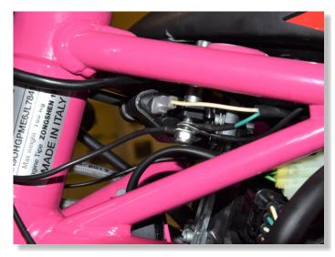
USE THE SUPPLIED BLACK JUMPER WIRE TO MAKE A CONNECTION BETWEEN THE BATTERY NEGATIVE TERMINAL AND CHASSIS GROUND, BY PLACING THE JUMPER WIRE TERMINAL UNDER THE BOLT OF THE IGNITION COIL.
