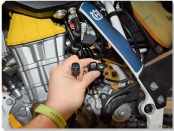
CONNECT THE QSH CONNECTORS IN-LINE WITH THE INJECTOR CONNECTORS.
