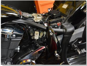
PLUG GPX CONNECTORS IN-LINE
