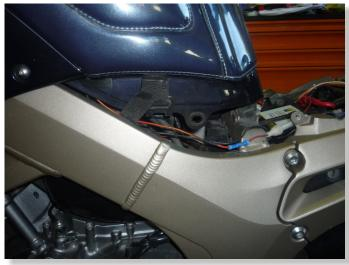
PLUG GPX CONNECTORS IN-LINE
