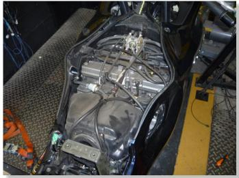
PLUG GPX CONNECTORS IN-LINE
