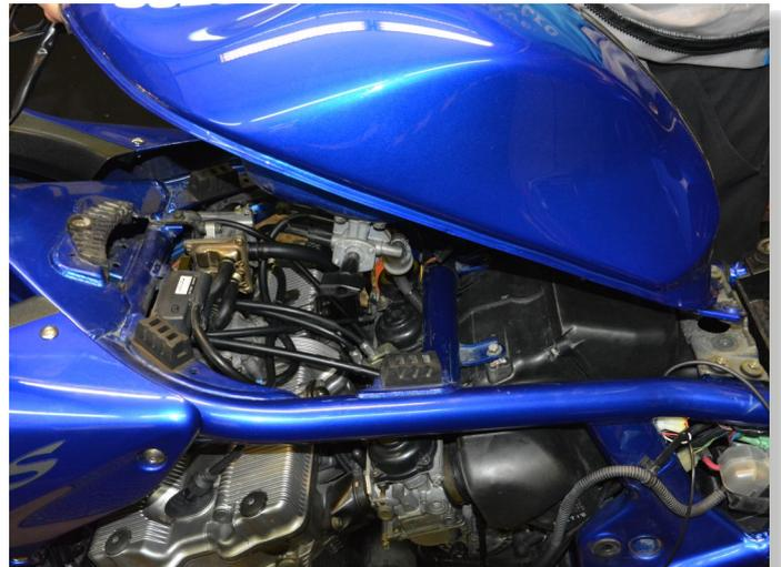
PLUG GPX CONNECTORS IN-LINE
