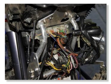
PLUG GPX CONNECTORS IN-LINE
