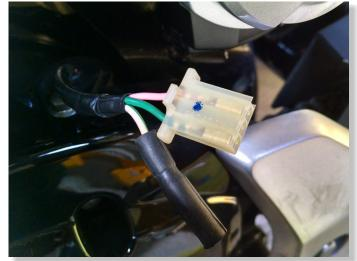
PLUG GPX CONNECTORS IN-LINE
