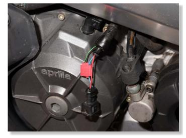
CONNECT GPX RED WIRE TO GREEN WIRE OF REAR BRAKELIGHT SWITCH CONNECTOR.
